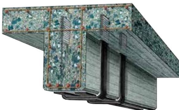
Como a seção de ancoragem final do Perfil em L do Sika CarboShear é pré-preparada no local, qualquer comprimento de trecho é possível. Devido à disponibilidade de diversos tamanhos de Perfil em L Sika CarboShear, podem ser reforçadas vigas estruturais de até 140 cm de altura e 140 cm de largura.
